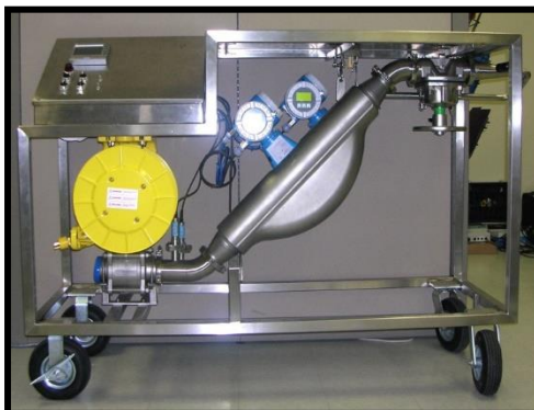
Figure 29. Exemple d'un ensemble utilisé par Endress+Hauser Canada pour la vérification et la certification des débitmètres dans l'industrie
